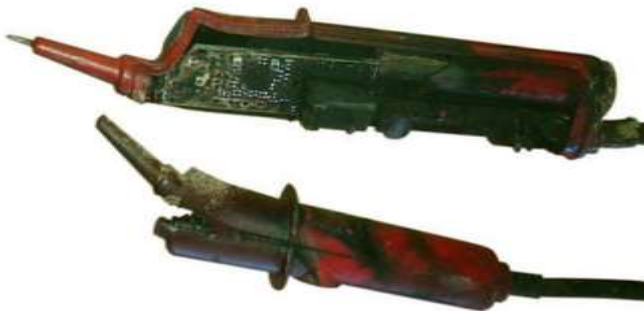
Bild: Zerstörter Spannungsprüfer nach Störlichtbogeneinwirkung (Quelle: BG ETEM)
